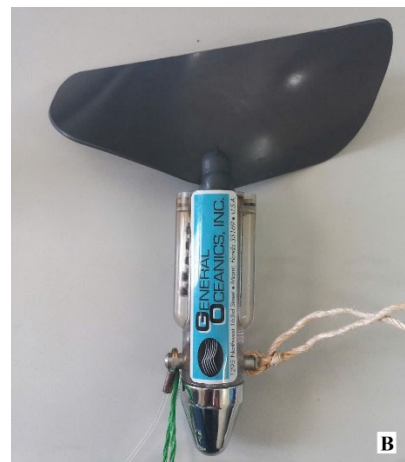
Hình 2. Thiết bị thu mẫu trứng cá, cá con (A) và thiết bị đo lượng nước qua lưới (B)
