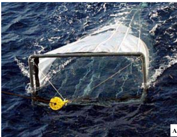
Hình 2. Thiết bị thu mẫu trứng cá, cá con (A) và thiết bị đo lượng nước qua lưới (B)
