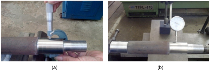
Hình 5. Kiểm tra kích thước và độ đảo cổ trục
