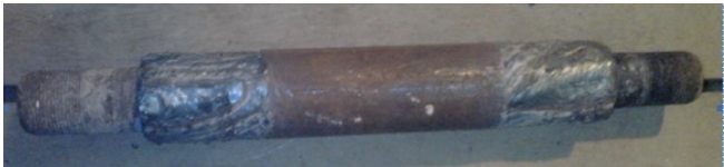
Hình 3. Trục máy xé đá sau khi hàn
