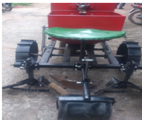
Hình 2. Bánh xe của một số máy trồng khoai tây với dạng mối hàn chữ T
