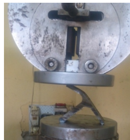
Hình 13. Kết quả thử bẻ liên kết hàn chữ T
