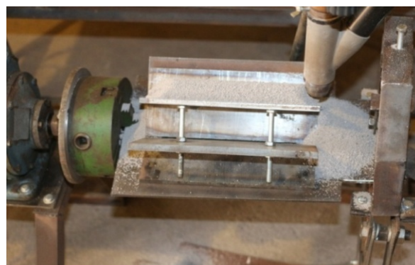
Hình 5. Quá trình hàn thực nghiệm các cặp mẫu
