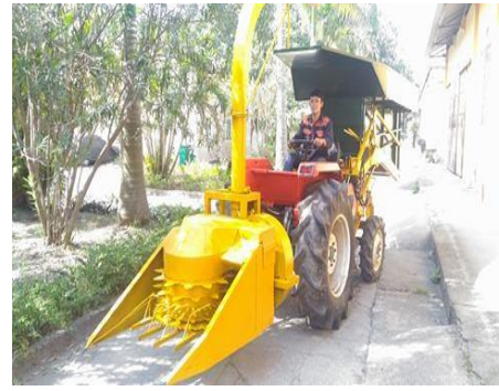
Hình 11. Liên hợp máy kéo - máy băm cắt cây nguyên liệu
