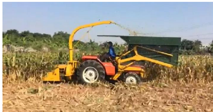
Hình 8. Thử nghiệm liên hợp máy thu hoạch cây ngô
