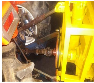
Hình 10. Kết nối và truyền động máy công tác và máy kéo
