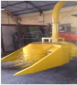
Hình 9. lắp ráp máy cắt băm
